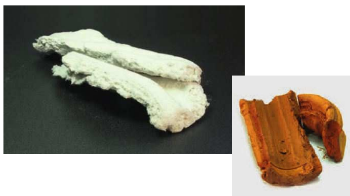
Príklady vysušeného filtračného koláča odstráneného z filtračného elementu
